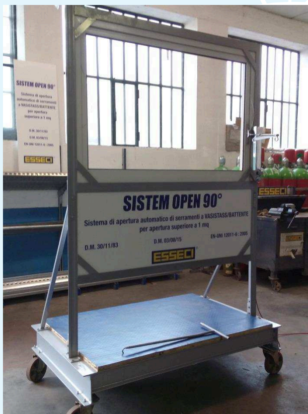
Fotografia del serramento posizionato in maniera che l'anta presentasse i cardini sull'asse orizzontale inferiore.
