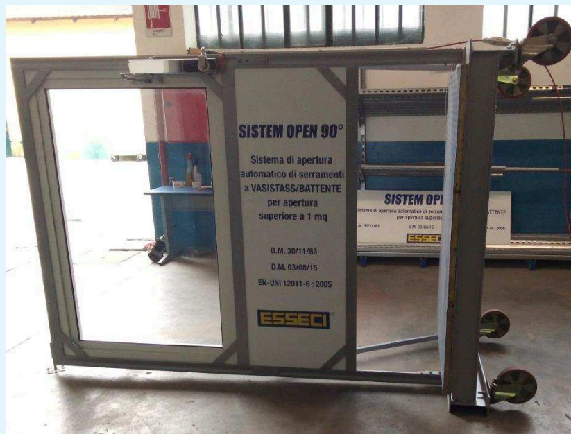
Fotografia del serramento posizionato in maniera che l'anta presentasse i cardini su un asse verticale.
