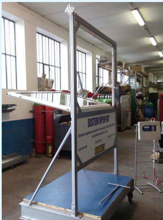
Fotografia del serramento disposto con l'anta con cardini su un asse verticale durante la prova.
